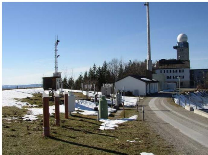
Abb. 6: Bulksammler (im Vordergrund) und weitere Niederschlagssammler am Observatorium Hohenpeißenberg des DWD (HP1)
