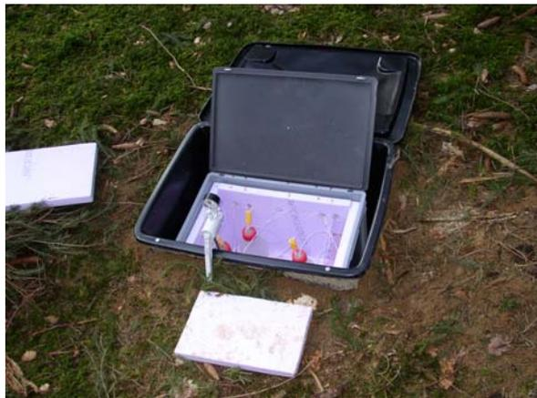
Abb. 10: Saugflaschen für die Sickerwasserprobenahme
