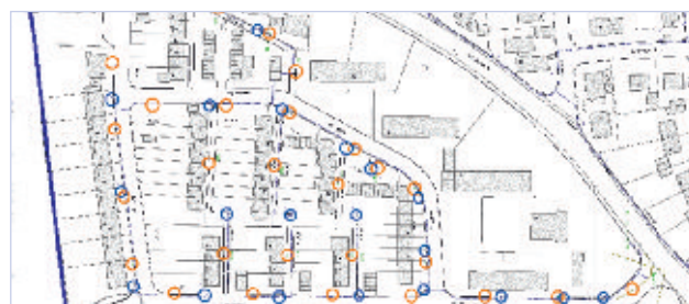
Tannenhofsiedlung mit Lichtpunktplanung; blau: bisherige Lichtpunkte, orange: neue Lichtpunkte; Lageplan: e.on Bayern
