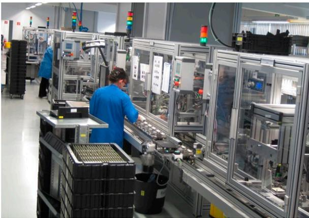
Montage- und Prüfanlage für Radarsensoren
