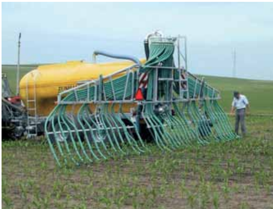
E14 | Ein wesentlicher Teil des durch den Menschen in die Atmosphäre eingebrachten Ammoniaks stammt aus der Tierhaltung. Um diese Emissionen bei der Gülleausbringung zu reduzieren, werden sogenannte Schleppschlauch- und Schleppschuhverteiler eingesetzt, welche die Gülle unmittelbar über der Bodenoberfläche ausbringen bzw. direkt in den Boden einbringen.
