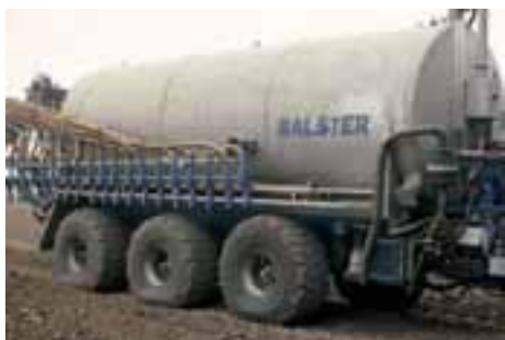
E22 | Traktor mit Zwillingsbereifung und Grubberkombination bei der mulchenden Bestellung (oben) und dreiaxsiges Güllefass mit Schleppschlauchverteiler und Reifendruckregelanlage (unten).
