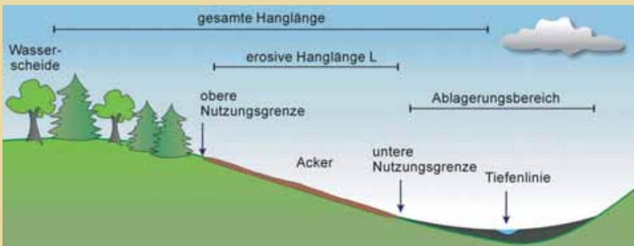
E29 | Die erosionswirksame Hanglänge beginnt, wo der Oberflächenabfluss einsetzt. CD
