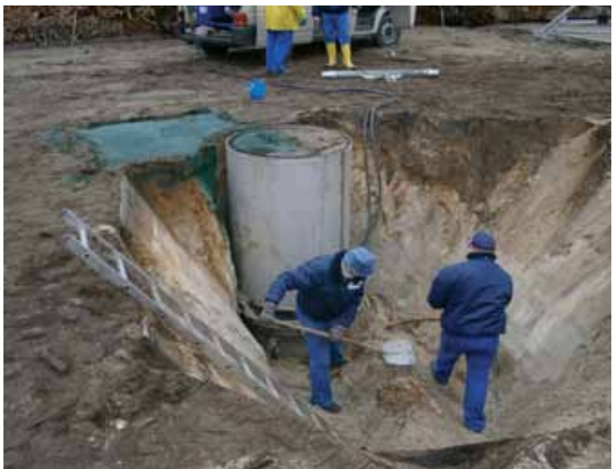
F7 | Unten: Um das Austragsverhalten von Schadstoffen aus dem Boden in das Grundwasser zu bestimmen, wird ein Bodenmonolith entnommen. Oben: Detail. An dem Standort sind über 70 Jahre chrom- und arsenhaltige Holzimprägniermittel in den Boden eingesickert.
