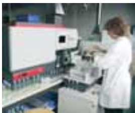
F9 | Die Konzentration von Schwermetallen wie Zink, Cadmium, Chrom, Kupfer, Nickel und Blei wird im Labor mit einem Emissionsspektrometer (ICP-OES) bestimmt.
