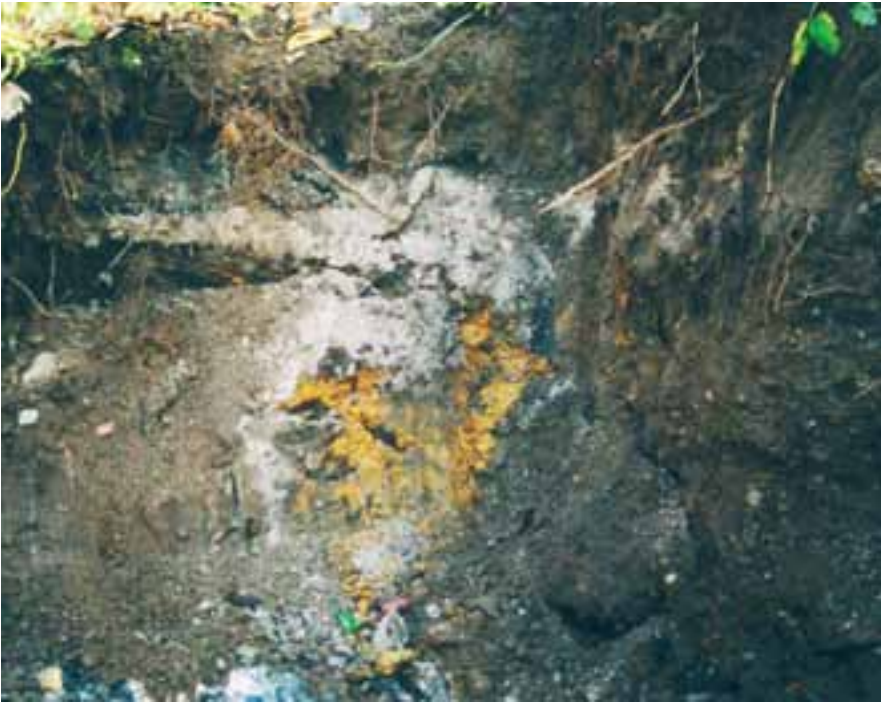
F8 | Ablagerungen von Zink- und Cadmiumsulfid im Boden.
