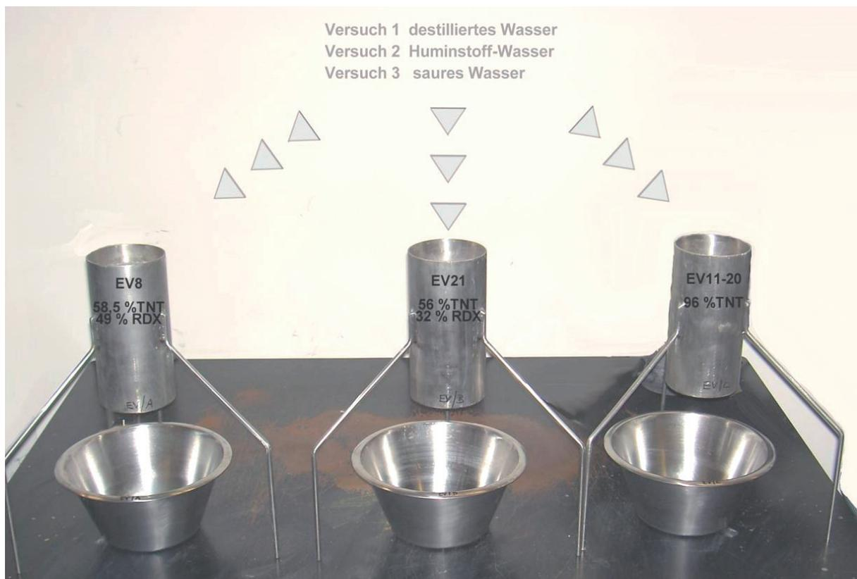
Abb. 8: Elutionszylinder und Versuchsstruktur. Die Prüfkörper bestanden aus 58,5/49 bzw. 56/32% TNT/RDX und 96% TNT. Sie wurden nacheinander mit destilliertem Wasser, Huminstoff-Wasser und saurem Wasser mit der Grundwassererneubildungsrate eines Jahres eluiert.
