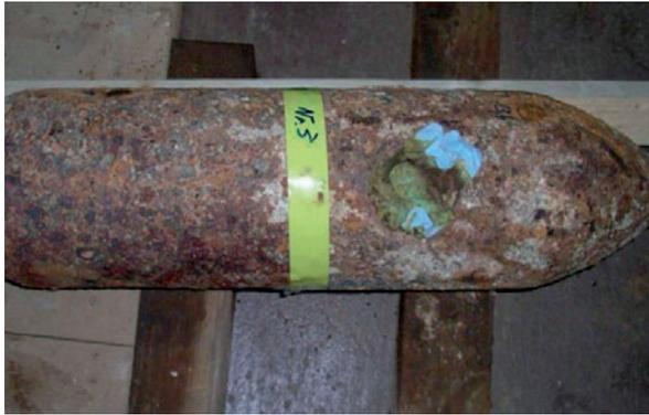
Abb. 37: SD50-Bombe (D, 2.WK) mit Ausblühungen von Pikrinsäure im Bereich des Zünders (gelb). Zum Aufsaugen der Ausschwitzungen wurde ein Tuch in die Mundlochbuchse eingeführt (blau).
