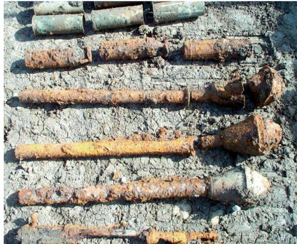
Abb. 33: Panzerfäuste 60. Der Zünder befindet sich im Trichter. Die ballistische Haube bildet nur einen relativ geringen Schutz gegen mechanische Einwirkungen.
