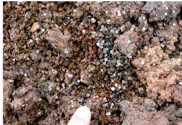
Abb. 17: Treibmittelrückstände, mit Blättchenpulver verunreinigtes Erdreich.
