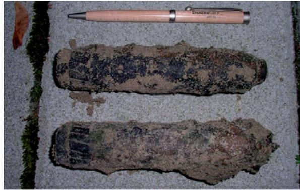
Abb. 38: Blindgegangene Gewehrgranaten 30. Sie haben nur schwache Distanzfedern.
