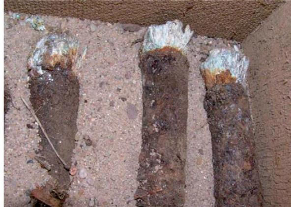
Abb. 40: 2 cm Granaten (Bordwaffenmunition) mit stark korrodierten Aluminium-Zündern.
