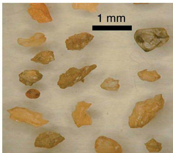
Abb. 47: Mikroskopische Darstellung von partikelförmigen TNT-Rückständen (flakes). Die Größen der Bröckchen liegt unter 1 mm.
