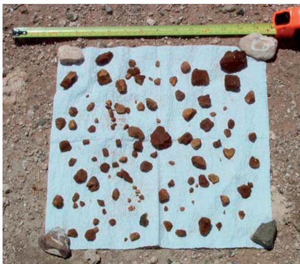
Abb. 46: TNT-Sprengstoffbrocken (chunks), eingesammelt auf einer 10x10 m großen Fläche im Umgriff eines Hartziels. Derartige Rückstände sind z.T. auch auf deutschen Sprengplätzen bei Böden mit wenig Bewuchs aufzufinden.
