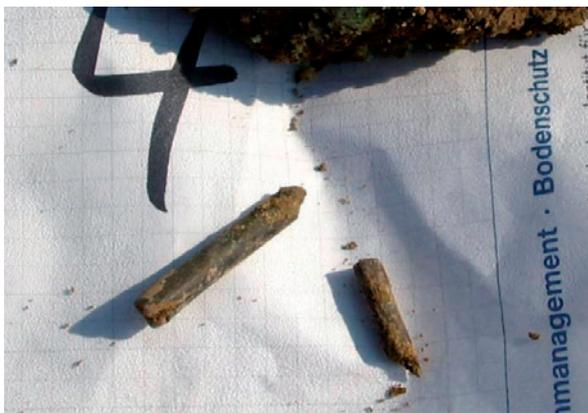
Abb. 18: Treibmittelrückstände, zerbrochenes Stäbchenpulver, aufgesammelt auf der Erdoberfläche im Trichterfeld eines Sprengplatzes.
