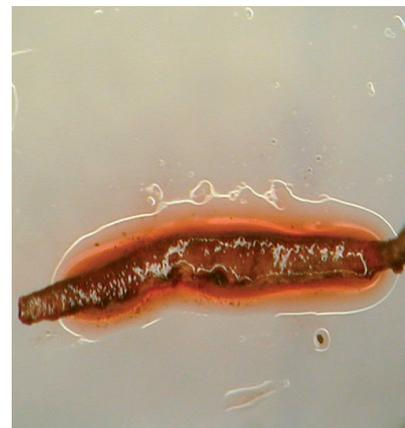
Abb. 21: Mikroskopische Aufnahme eines faserigen NC-Pulverrückstands. Nach der Zugabe eines Reagens verfärbt sich das im Pulver enthaltene 2,6-DNT rötlich.
