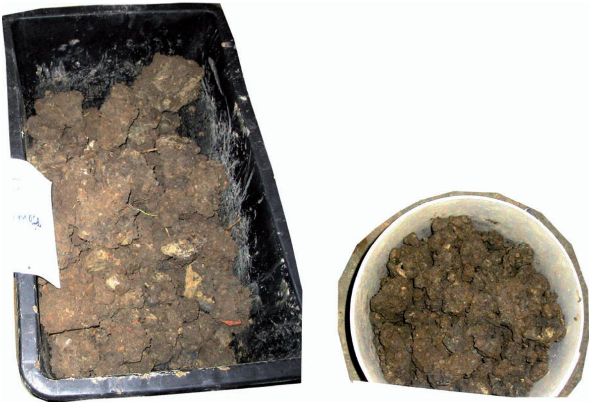
Abb. 42: Schlecht homogenisierbares rückverfülltes Auswurfmaterial. Links vor, rechts nach intensiver Homogenisierung.
