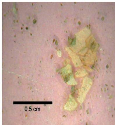
Abb. 20: Plättchen, die vermutlich aus Nitrocellulose (NC) bestehen.
