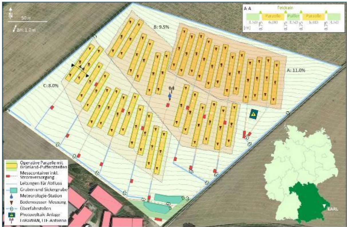
Abb. 10: Versuchsanlage des Erosion and Runoff Laboratory (EARL) in der Zukunftswerkstatt Ruhstorf. © Johannes Mitterer, LfL
