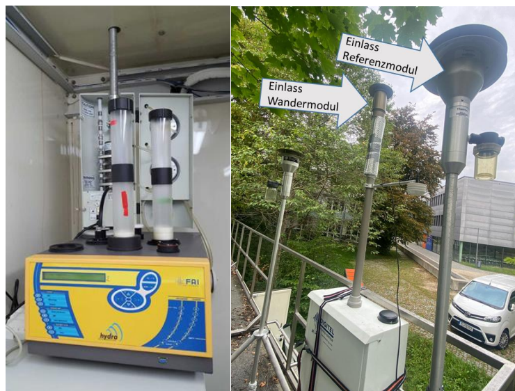
Abbildung 10: Fotografien des Aufbaus für das Referenzmodul im Messcontainer sowie die Vergleichsmessung mit dem Wandermodule auf dem Dach für eine der beiden Messkampagnen in Augsburg.
