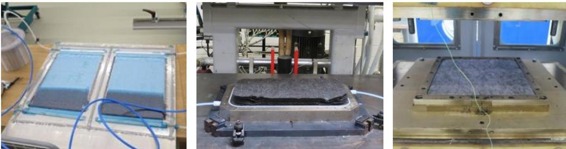
Abbildung 26: Weiterverarbeitung CF-Vliese zu CFK – VARI-Prozess mit Epoxidmatrix (links), RTM-Prozess mit Epoxidmatrix (mittig), Heizpressverfahren mit Polypropylenmatrix (rechts) [19], [20]
