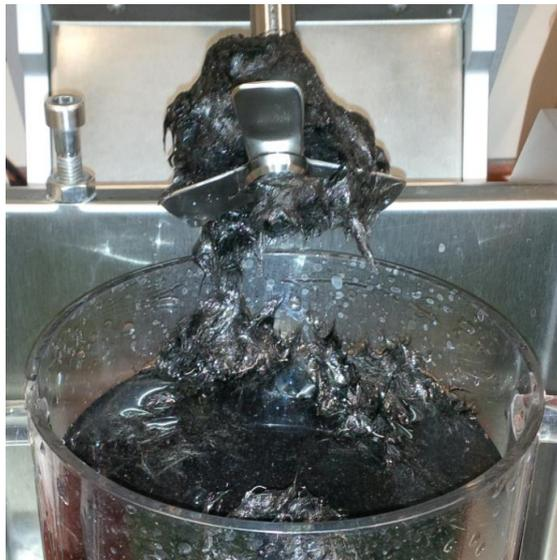
Abbildung 23: Rotor mit Faserumschlingungen
