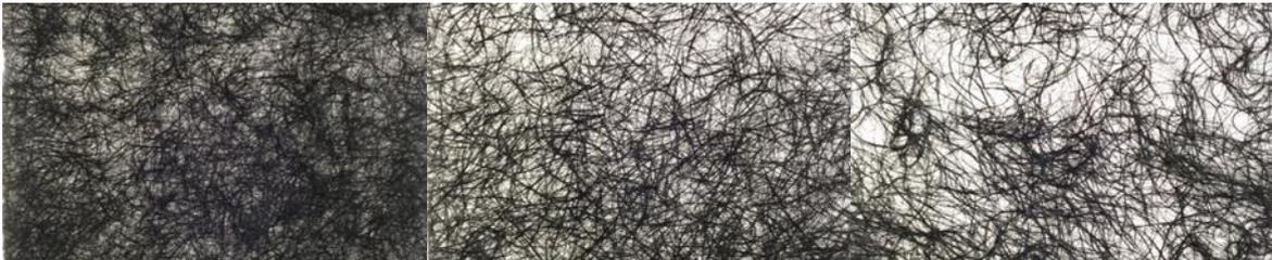
Abbildung 24: Nassvliese aus CF mit 12 mm (links), 18 mm (mittig) und 36 mm (rechts) Faserlänge [19]
