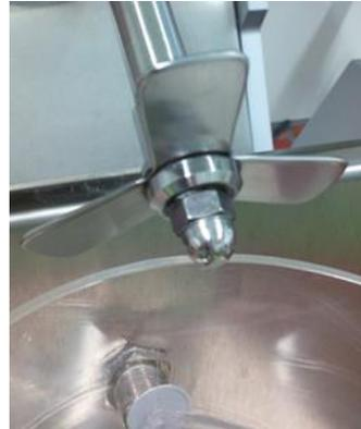
Abbildung 19: Aufschlaggerät (links), Detail: Propeller mit abgerundeten Kanten (rechts).
