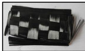
Abbildung 11: Separierte Carbonfasern nach dem Recycling mittels superkritischer Fluide.
