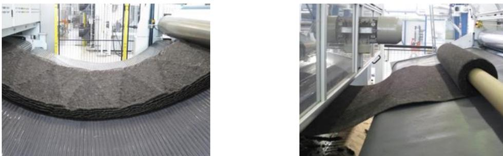
Abbildung 25: Trockenvlies - Kreuzlegung (links) mit anschließender Vernadelung (rechts) [20]
