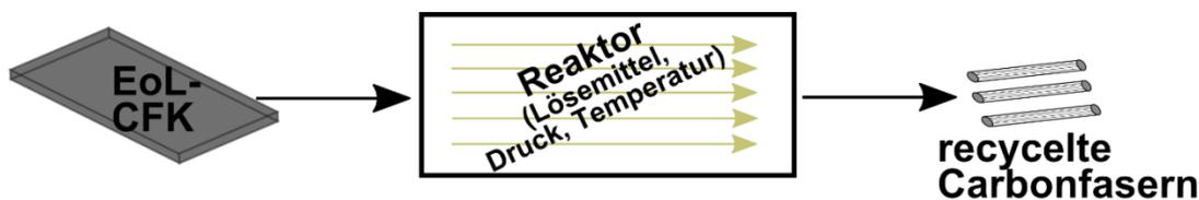
Abbildung 10: Skizze zum Funktionsprinzip des Recyclings von Carbonfasern mittels superkrit. Fluide
