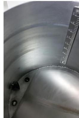
Abbildung 20: Laborbütte (links), Detail: Skala für Füllstand und Propeller (rechts).
