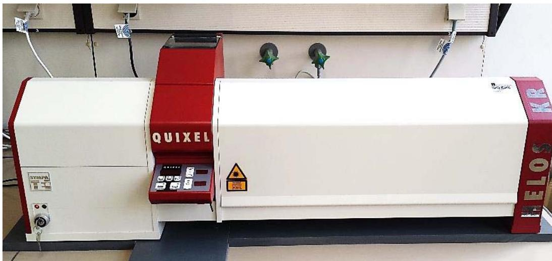
Abbildung 6-1: Zur Partikelcharakterisierung verwendete Laserbeugungsspektrometer Helos KR mit Nassdispergiereinheit QUIXEL.
