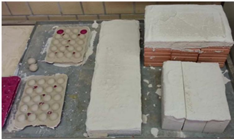
Abbildung 6-7: Modellsysteme Gipsputzkugel, gipsputzverputzter Porenbeton, Tonziegel und Kalksandstein (von links nach rechts)
