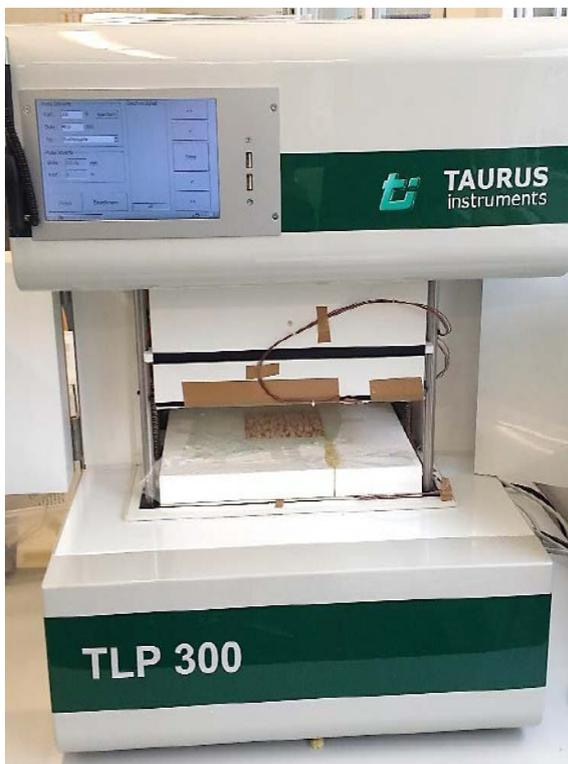
Abbildung 6-6: Taurus instruments TLP 300 zur Messung der Wärmeleitfähigkeit, Styroporrahmen mit Probe in Probenkammer.
