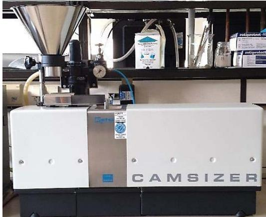
Abbildung 6-2: Zur Partikelgrößenanalyse verwendetes Messsystem „Camsizer P4“ der Firma Retsch Technology.
