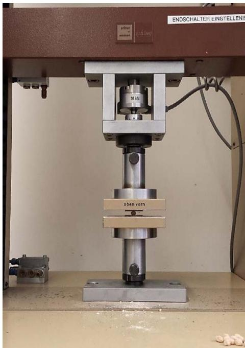
Abbildung 6-5: Frank Universalprüfmaschine zur Druckfestigkeitsbestimmung der erzeugten Agglomerate.
