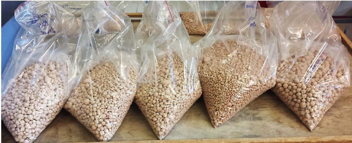
**Abbildung 8-7:** Abbildung einiger mittels Intensivmischer hergestellten Agglomerate, nach dem Trocknen bei 105 °C im Trockenschrank. Massenanteil Keramik/Ziegelbruch in Prozent von links nach rechts: 90/10, 80/20, 70/30, 60/40, 50/50.
