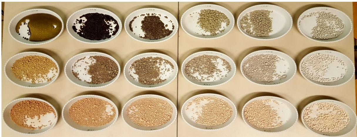
**Abbildung 8-9: Gebrannte Agglomerate aus Keramik- und Ziegelbruch. Abbildung der Zusammensetzungen mit von links nach rechts zunehmendem Keramikanteil. Von rechts: 90 %, 80%, 70%, 60%, 50 % Massenanteil Keramikbruch, reiner Ziegelbruch. Abnahme der Brenntemperatur von oben nach unten. Von oben: 1400 °C im Tunnelofen, 1170 °C im Drehrohrofen, 900 °C im Glühofen.**
