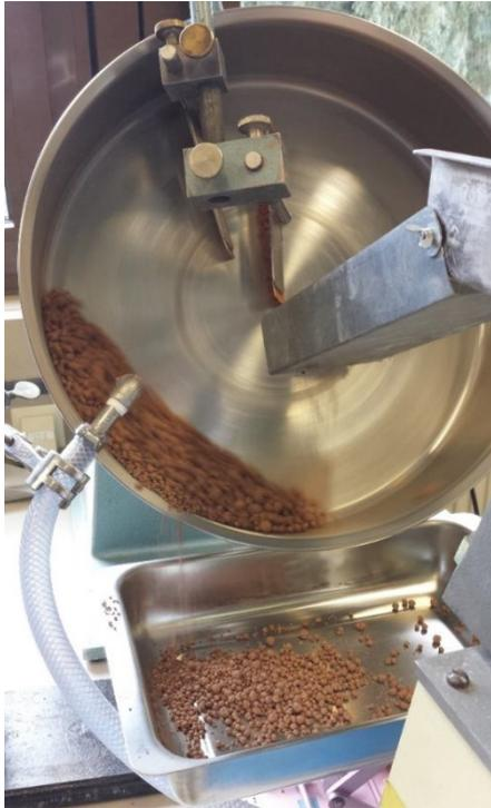
Abbildung 6-3: Im Versuch verwendeter Granulierteller zur Aufbauagglomeration mit Ziegelmaterial. Oben im Bild sind zwei Schaber, links die Wasserdüse, rechts die Vibrationsrinne und unten der Auffangbehälter zu erkennen.
