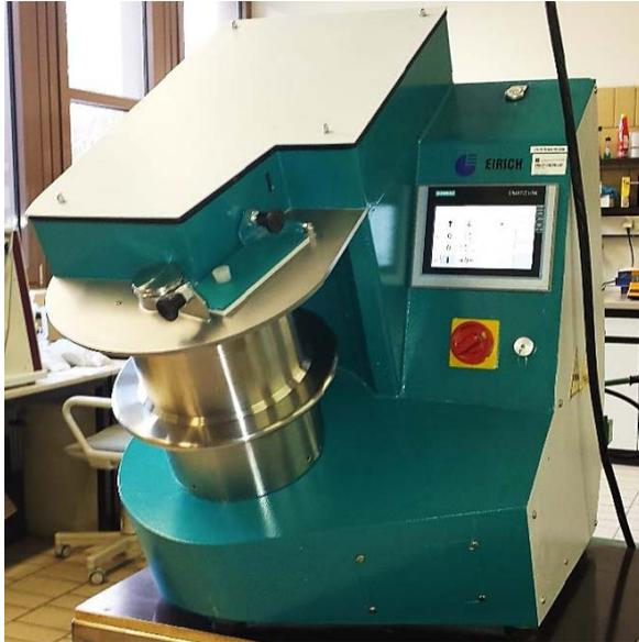
Abbildung 6-4: Im Versuch zur Aufbauagglomeration verwendeter Eirich-Intensivmischer.
