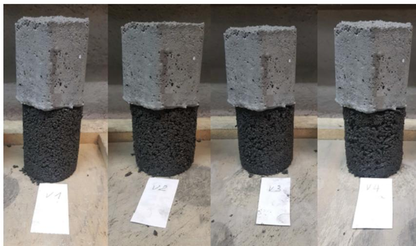
**Abbildung 19:** V 1-V 4: Festigkeitstest nach 60 Minuten.
