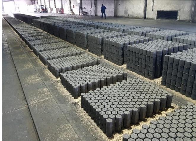
**Abbildung 12:** Produktionshalle der Serienfertigung von SiC-Formlingen beim Projektpartner GPS SiC Keßl GmbH.
