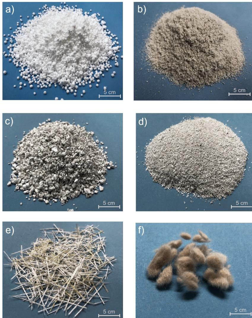
**Abbildung 2.22:** Exemplarische Darstellung der rückgewonnenen Sekundärrohstoffe aus den WDVS-Abbruchmaterialien; EPS aus der GF (a), XPS aus der GF (b), Putz aus der GF(c), Putz aus der FF (d), Glasfasern aus der GF (e) sowie Glasfaseragglomerate aus der FF (f)
