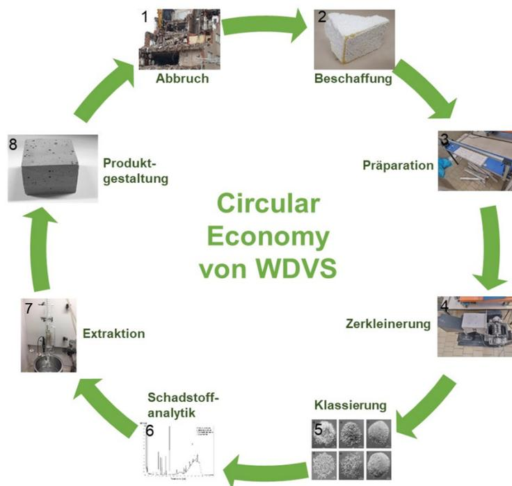
**Abbildung 2.5:** Möglicher Geschlossener Stoffkreislauf von WDVS
