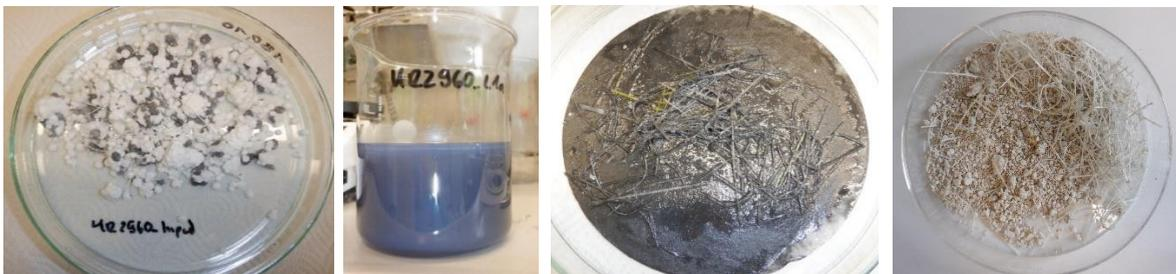
**Abbildung 2.31:** von links nach rechts: EPS Inputfraktion, nach Auflösung in einem CreaSolv® Lösemittel, Filtrerrückstand, getrockneter Filtrerrückstand
