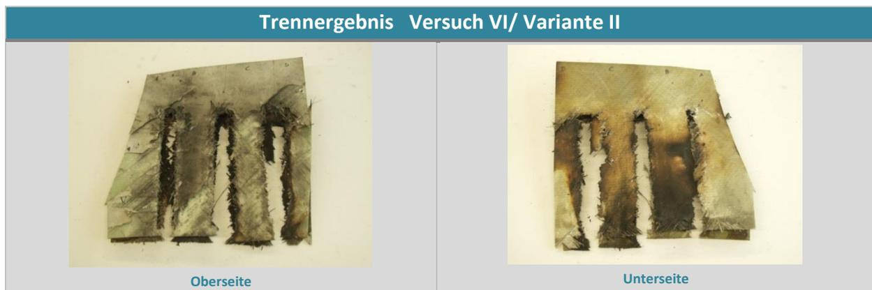
**Abbildung 13: Ergebnis der Sprengkonfiguration Variante II mit erhöhter Leistung an GFK-Kunststoffschaum-Verbund**
