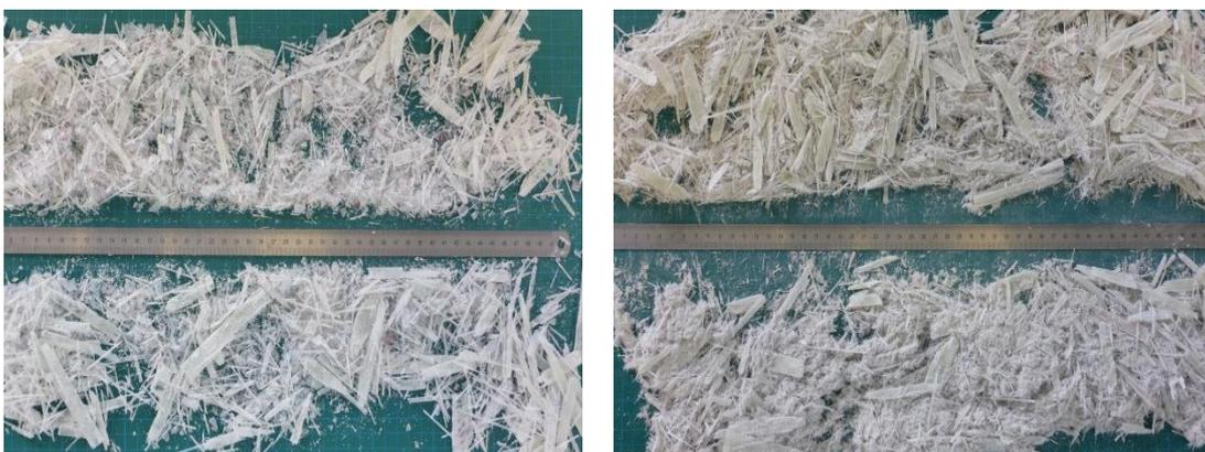
**Abbildung 18: Zerkleinerte GFK-Proben (links) HM20/12 (rechts) HM20/57**
