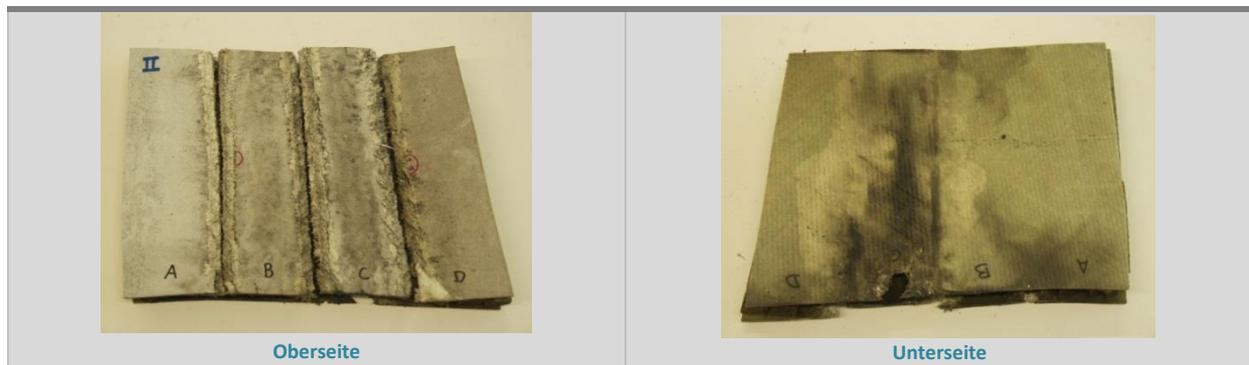
**Abbildung 12: Ergebnis der Sprengkonfiguration (Variante I) mit GFK-Kunststoffschaum-Verbund**
