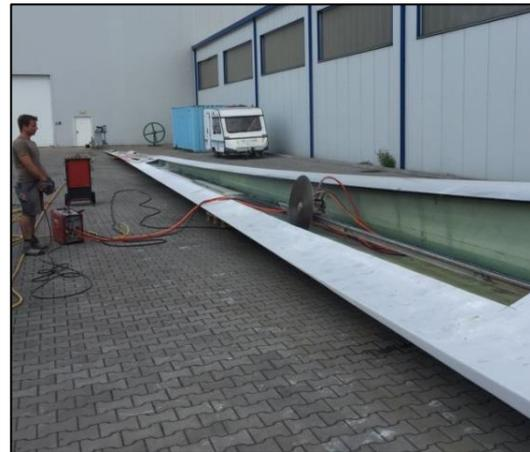
**Abbildung 15: Versuche zur Zerlegung eines Rotorblattes mittels Bandsäge**
