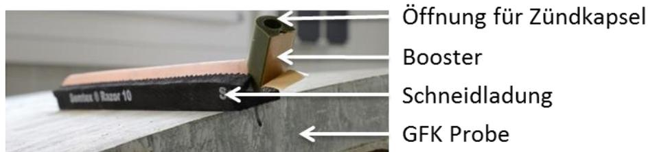
**Abbildung 10: Aufgebrachte Schneidladung (Belegungsdichte 140g/m) auf einer GFK Probe**
