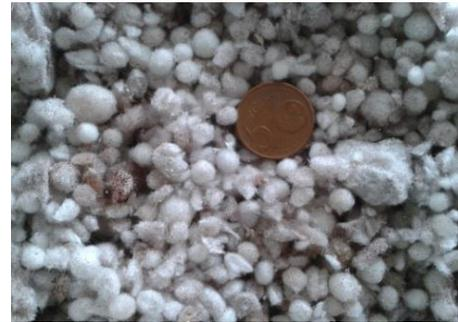
**Abbildung 24: gewaschene und getrocknete G-Fasern aus den Versuchen a) RB (PEG 400, 24) und b) GFK (PEG 400, 25)**
