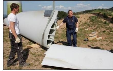
**Abbildung 6: geteiltes Rotorblatt für genehmigungsfreien Abtransport**
