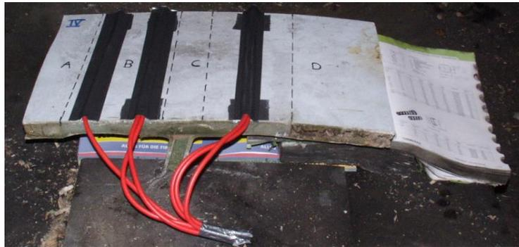
**Abbildung 8:** Auf dem Versuchstisch im Sprengbunker positioniertes Prüfsegment (Variante I)
