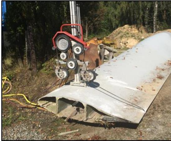
**Abbildung 14: Versuche zur Trennung eines Rotorblattes mittels Seilsäge**
