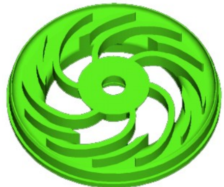
Ergebnis aus Strömungssimulation und Optimierte Lüfterradgeometrie
