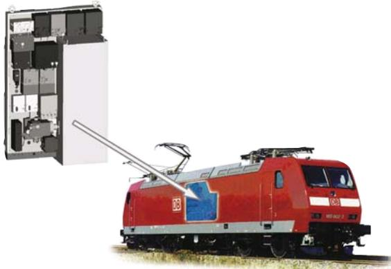
Einbausituation der Bremssteuerung in einem Schienenfahrzeug
