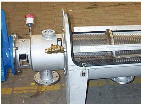
Ansicht der neuen nach IPP-Prinzipien entwickelten Schneckenpresse
