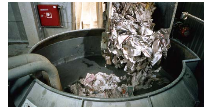
Stoffpulper – Auflösung von Altpapier Foto: Verband deutscher Papierfabriken e. V.
