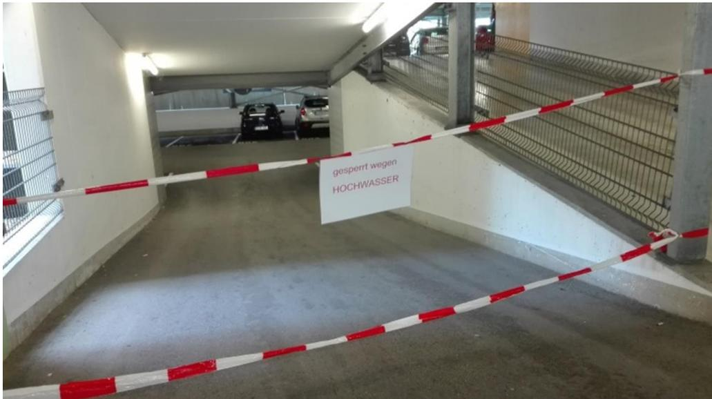
*Abbildung 1: Beispiel einer organisatorischen Maßnahme - Gemäß Alarm- und Einsatzplan wird die Zufahrt ins Tiefgeschoss des Parkhauses bereits bei drohenden Starkregenereignissen als Vorsorgemaßnahme gesperrt.*
